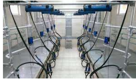
รูปที่ 5 pipeline milking system
